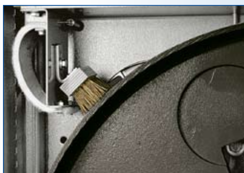
Raschiatori sui volani Scrapers on flywheels Racleurs sur les volants Bürste an der unteren Bandsägerolle Cepillos en los volantes
