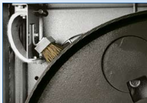
Raschiatori sui volani Scrapers on flywheels Racleurs sur les volants Bürste an der unteren Bandsägerrolle Cepillos en los volantes
