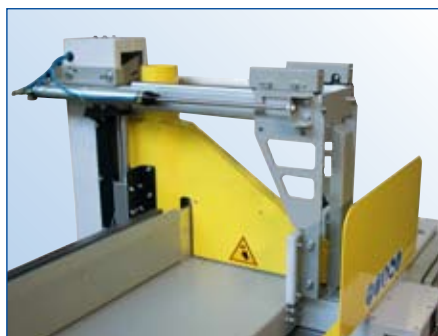
BGZ 00386 Doppio pressore frontale. Double front clamp (packer). Double presseur frontal (empaqueteur). 2 stk. Vordere niederhalter (stampler). Doble prensor delantero (empaqueador).
